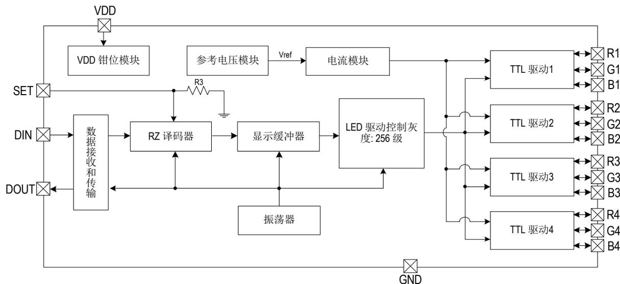
Fig. SM16712PD 内部功能框图
