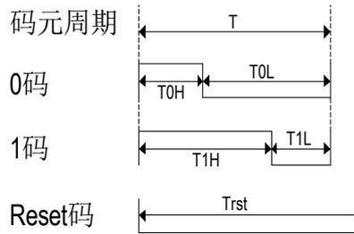
Fig. SM16712PD 归零码数据通信协议图
