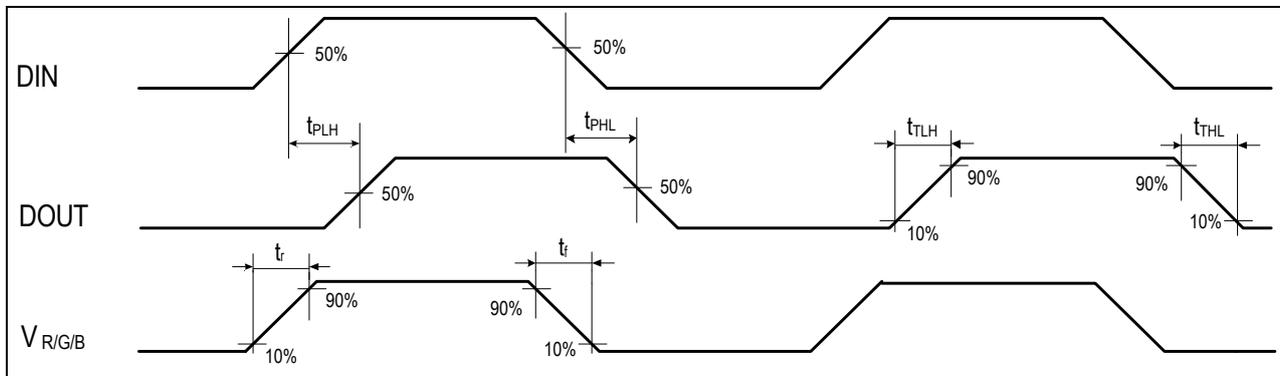
Fig. SM16712PD 动态参数测试示意图
